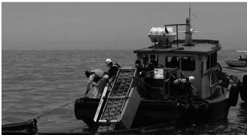
Foto: Operaciones de Recuperación de hidrocarburos utilizando skimmers en «embarcaciones de fortuna» - Gentileza: Diego Etcheverri (LAMOR - Perú)
